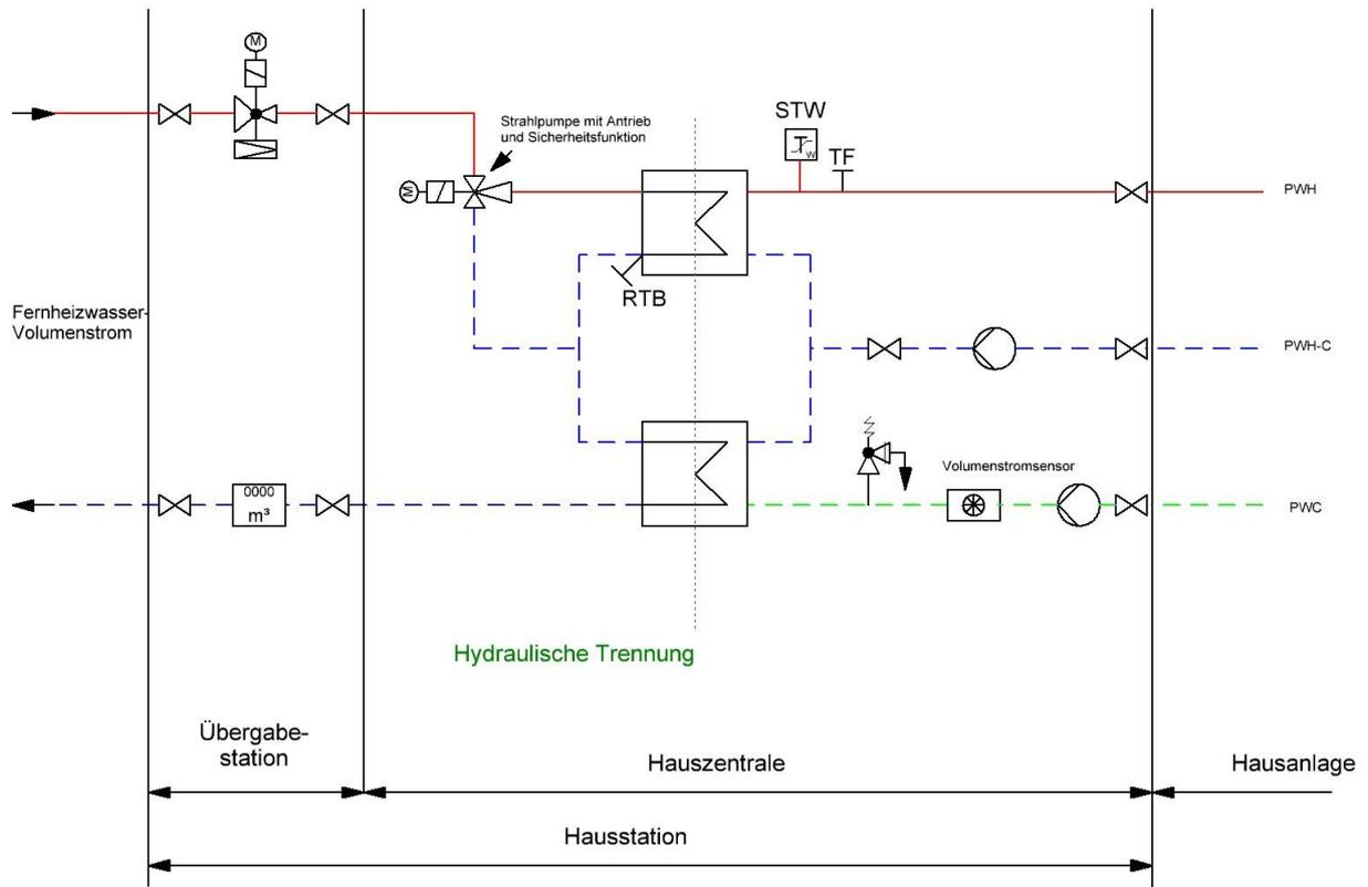
Der primärseitige Anschluss muss den Regeln der TAB entsprechen. Hierfür sind die netzspezifischen Datenblätter je Netzgebiet zu verwenden. Insbesondere hinsichtlich Druck  $P_s$  und Temperatur  $T_s$ .
