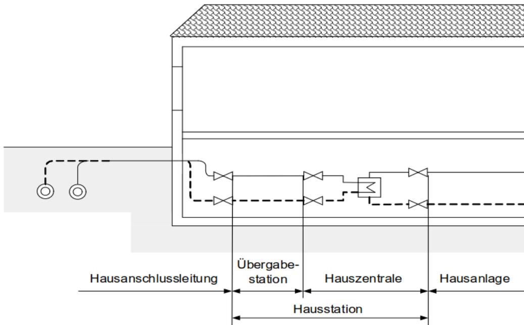
Abbildung 6: Hausanschlussleitung und Hausstation (Definition abgeleitet aus DIN 4747)
